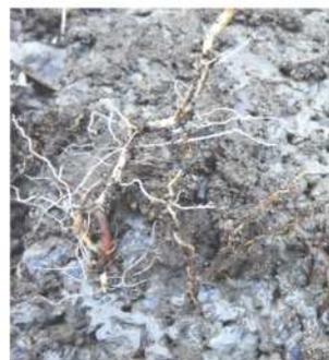
ポーラスコンクリートへの植物の導入はかなり困難でしたが、合成樹脂基盤ベストマンパレットを用いることでポーラスコンクリートにも植物を定着させることができます。植物の根はポーラスコンクリートの隙間を伸びることができます。
