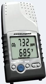
NDIR（非分散形赤外線吸収法）により、ppm レベルで CO<sub>2</sub> の測定が可能な、片手におさまる CO<sub>2</sub> 測定機です。
