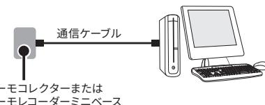
2. サーモレコーダーの光通信部がずれないよう、下図のようにセットしてください。
