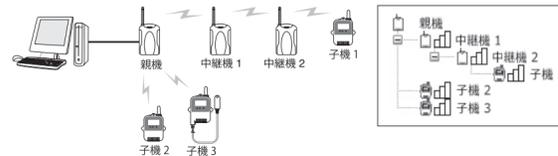
電波強度が弱い場合は、よい結果が得られるまで設置場所の調整と電波強度の確認作業を繰り返してください。
