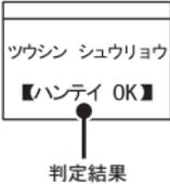
② パソコンで上下限値の詳細を設定し、判定を [ON] に設定してある場合、図のように判定結果のメッセージが表示されます。
