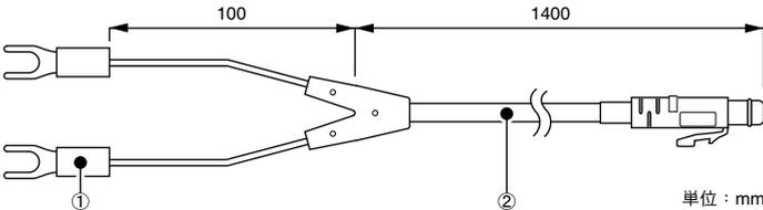
材質：① M3.5 圧着端子 ②塩化ビニール被覆電線
