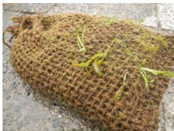
生分解基盤の沈水植物マットは生分解性基盤に植栽された沈水植物の苗とヤシ繊維の袋の組み合わせによって構成されています。沈水植物が取り付けられたヤシ繊維の袋に現地発生土を充填することで、波浪や流れのある河川や湖沼環境において容易に沈水植物の植栽ができるようになりました。
